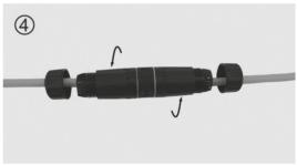
4. Schrauben Sie das lange Rohr fest auf die RJ45-Kupplung, wie in der Anleitung beschrieben.
