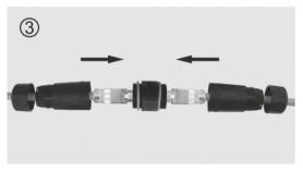
3. Stecken Sie das Patchkabel in die beiden Enden der RJ45-Kupplung.
